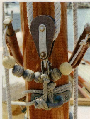
Details nach Vorväterart: Das Großsegel wird mit Piek- und Klaufall gesetzt
