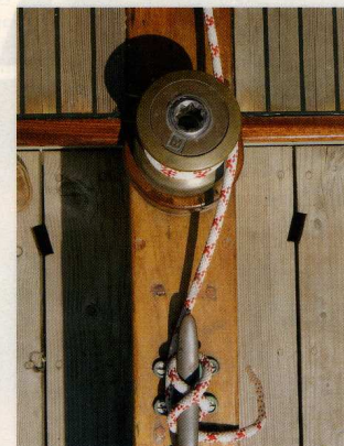
Gebrauchsspuren an Bronze, Teak und Mahagoni: Das Testschiff war sieben Jahre alt
