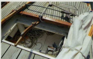
Sicher stauen: wasserdichtes Fach für Motor und Ausrüstung im Achterschiff
