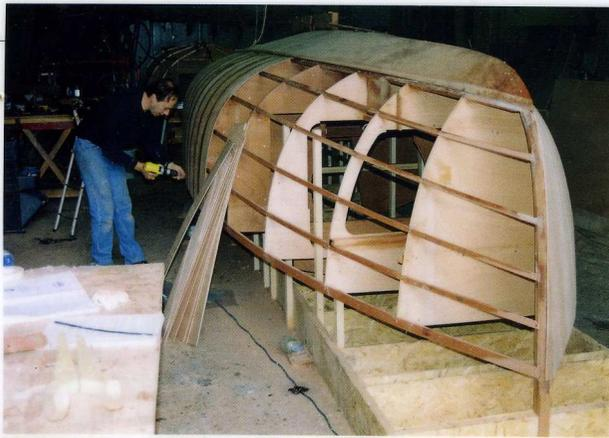
**Ci-contre:** le Méaban est entièrement construit en contre-plaqué. Si une partie de son bord est développable, l'autre doit être traitée en contre-plaqué moulé.
